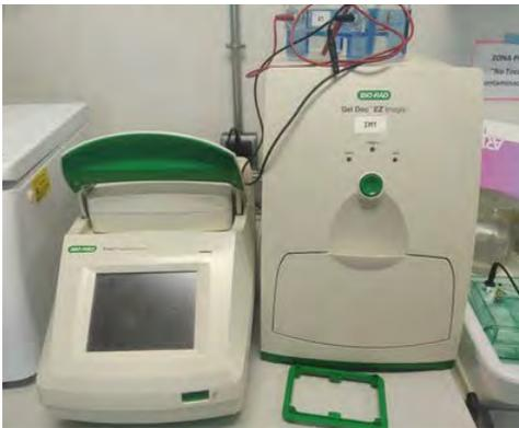
El Gel Doc EZ es un sistema de imágenes compacto y automatizado. Las bandejas específicas para diferentes aplicaciones brindan flexibilidad y el software Image Lab™ brinda imágenes con calidad de publicación y resultados analizados con solo presionar un botón.
