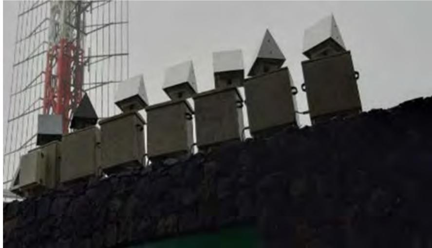
**PM 10:** Cabezal para la selección de partículas inferiores a  $10 \mu$  para filtros de  $15 \text{ cm } \varnothing$ . Construido según normativa europea EN12341 e informe de equivalencia del Instituto de Salud Carlos III. Cabezal apto para trabajar con los captadores de MCV modelos CAV-A/Mb y CAV-A/MSb.
