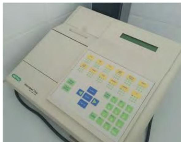
El espectrofotómetro UV/visible **SmartSpec Plus** tiene un rango de longitud de onda de trabajo de 200 a 800 nm. Es la herramienta perfecta para aplicaciones rutinarias como:
