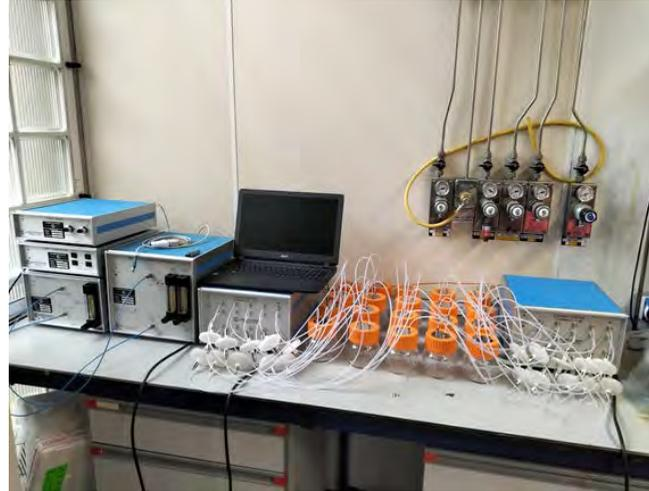
Equipo de bucle cerrado (sensibilidad de  $0,2\mu\text{L/h}$ ) para mediciones de oxígeno y dióxido de carbono.
