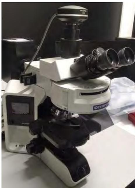
El microscopio modular BX43 permite escoger configuraciones rentables o avanzadas conforme a sus necesidades. Los componentes modulares, como las platinas y los tubos de observación ergonómicos, permiten personalizar fácilmente el microscopio para adaptarlo a su aplicación.
