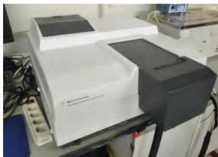
El Cary 100 es un espectrofotómetro UV-visible rentable con un conjunto versátil de accesorios para el trabajo de laboratorio de rutina.
