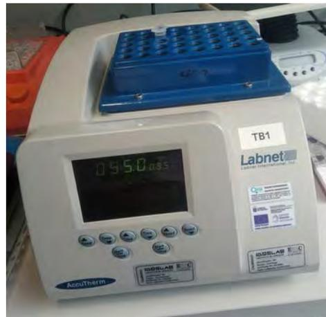
Control por microprocesador de tiempo, agitación y temperatura. Velocidad: 300 a 1500 rpm. Orbita: 2 mm. Rango de Temperatura: Ambiente -14°C a 100°C.
