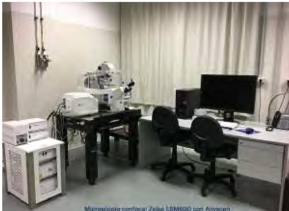
El microscopio **Confocal Zeiss LSM800** es flexible y compacto, con detectores de GaASP y escáner de alta velocidad de barrido. Además, cuenta con un revolucionario detector, el Airyscan, patentado por la casa comercial Zeiss.
