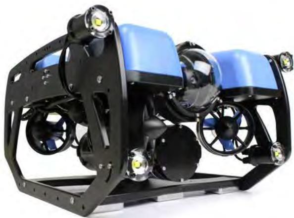
El SIANI adquirió en el 2019 este robot que va equipado con una cámara gran angular de alta definición (1080p, 30 fps) capaz de trabajar con poca luz. Está montado en un mecanismo para que el piloto pueda controlar la inclinación de la cámara para mirar hacia arriba o hacia abajo.
