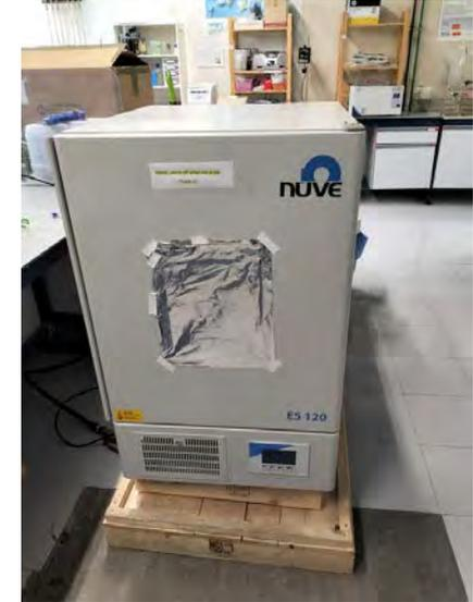
Posee 123L de capacidad, y sistema de control N-Smart para el almacenamiento de registros de temperatura.
