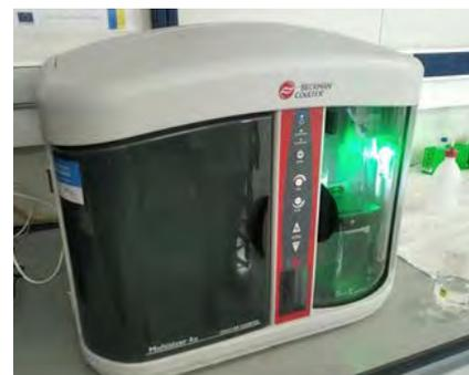
Utiliza el principio Coulter para detectar partículas mediante detección de zona eléctrica, independientemente de la naturaleza o las propiedades ópticas de la partícula por lo que es una herramienta para detectar y realizar recuentos de una amplia variedad de partículas, como:
