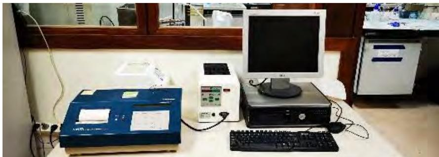
Sistema de medición de Toxicidad mediante la medida de la luminiscencia de las bacterias del tipo *Vibrio Fisheri*, un microorganismo sensible a un amplio número de compuestos.
