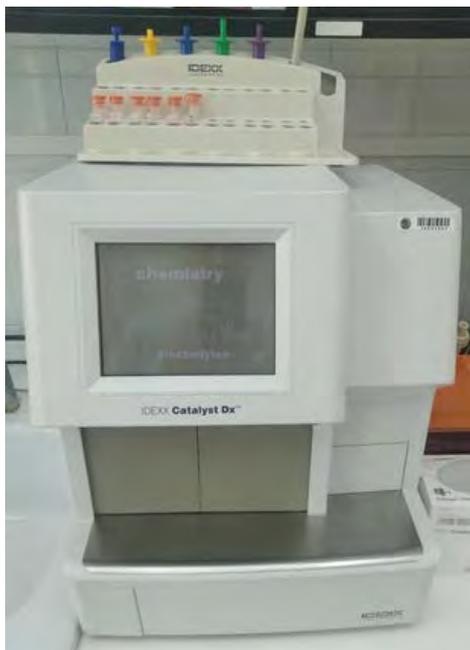
La flexibilidad del menú de análisis del analizador bioquímico Catalyst Dx permite: monitorizar el estado de salud de órganos concretos, realizar un seguimiento de los valores durante un periodo de tiempo, personalizar los perfiles
