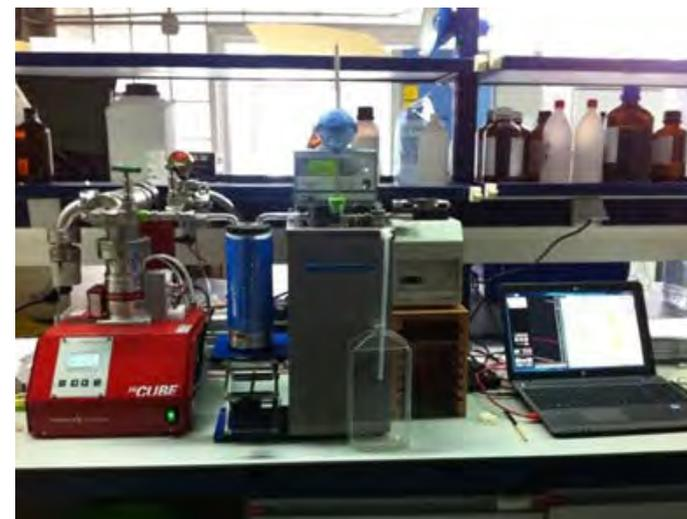
Permite hacer análisis de espectrometría de masas de membrana para estudiar la composición de gases como argón, oxígeno, nitrógeno, y sus relaciones.
