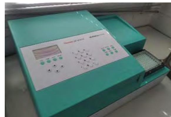
El **Multiskan EX** es un fotómetro básico para lectura de microplacas de 96 pocillos en ensayos cinéticos y de punto final, especialmente adaptado para aplicaciones de inmunoensayos enzimáticos (EIA).
