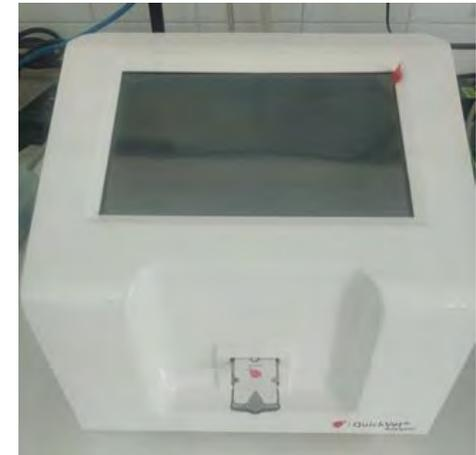
Analizador automático para la determinación de parámetros de coagulación (PT y APTT) y de Fibrinógeno y proteína de fase aguda.
