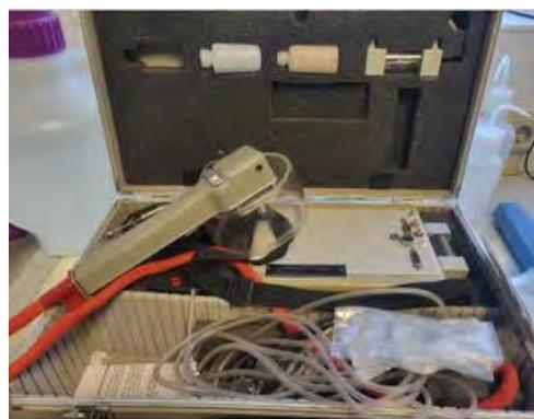
El equipo LC-PRO es una herramienta útil y eficaz para la medición de la respiración del suelo, en lo relativo al pronóstico, inventario y el control de trabajos de saneamiento, para mediciones de la desintegración bioquímica de sustancias (pesticidas, fungicidas, abonos...), así como para la realización de pruebas de toxicidad.
