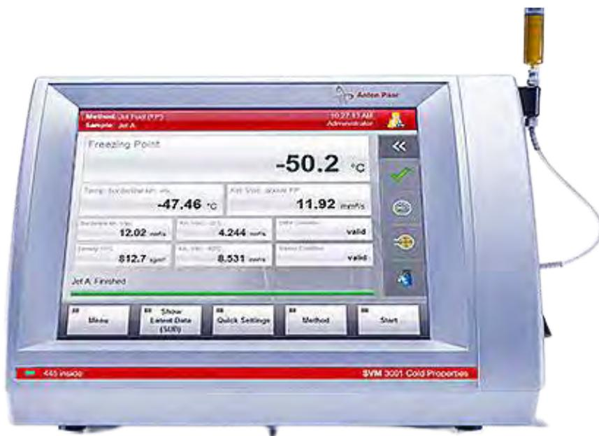
Para poder calcular la viscosidad cinemática basada en la viscosidad dinámica, debe conocerse la densidad de la muestra por eso está equipado con una celda de medición de densidad, según el conocido principio de oscilación del tubo en "U". Ambas celdas se llenan en una fase de trabajo. Las mediciones se realizan simultáneamente.
