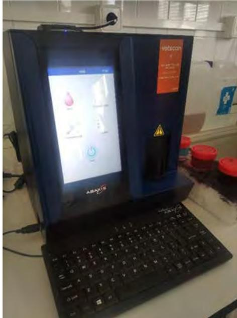
Es un contador de células de 5 partes de glóbulos blancos, completamente automatizado, que brinda un recuento integral sanguíneo completo de 24 parámetros (CBC) con histogramas celulares en minutos
