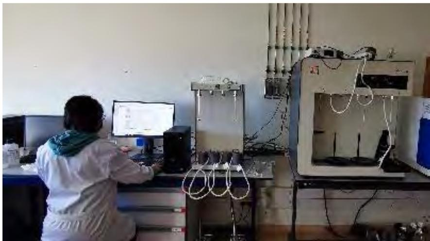
La adsorción física –o **fisorción** de gases es una técnica de análisis de propiedades texturales (superficie específica, volumen y tamaño de poros) basada en la interacción que tiene lugar entre un gas (adsorbato) y el sólido que se quiere caracterizar (adsorbente).
