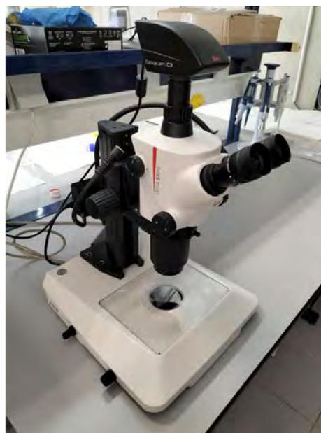
El Microscopio Estereoscópico Leica SAPO tiene cámara, y sistema óptico Greenough 12° con zoom apocromático 8:1
