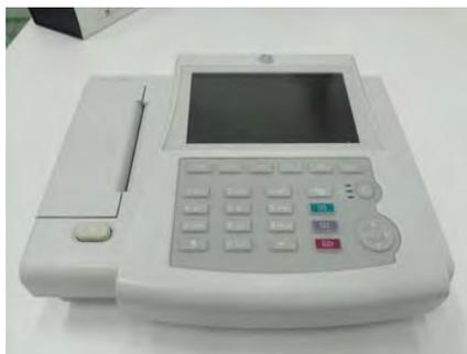
Equipo de estudio electrocardiográfico de 6 canales con pantalla de visualización e impresión en láser. Equipado con electrodos monopolares, bipolares y precordiales.
