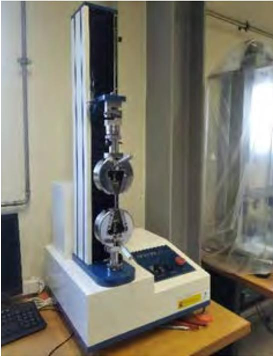
Se utiliza para determinar propiedades mecánicas de diferentes materiales, principalmente poliméricos. Ensayo de tracción, compresión y flexión.
