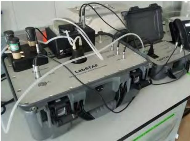
LabSTAF proporciona una plataforma altamente automatizada para ejecutar curvas de luz de fluorescencia (FLC) continuas.
