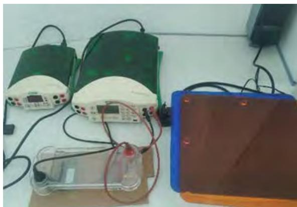
La fuente de alimentación HV admite una salida de 5000 V, 500 mA y 400 W, lo que permite su uso para todas las aplicaciones de alto voltaje, incluidas las aplicaciones de baja corriente en el rango de microamperios. Es ideal para IEF y secuenciación de ADN. Con una salida de 400 W, el PowerPac HV ofrece suficiente potencia para ejecutar los experimentos IEF más exigentes o hasta cuatro células de secuenciación de ADN simultáneamente.
