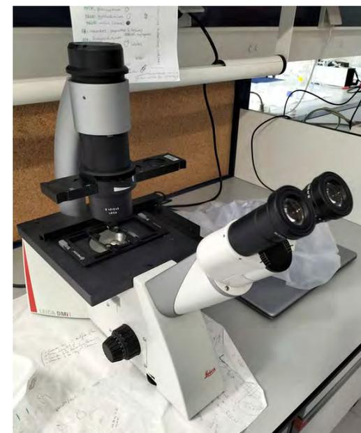
El Microscopio Invertido DMI1 tiene una cámara integrada de 12 MP y condensador S40/0,45 (40-50 mm de distancia de trabajo) para una óptima resolución.
