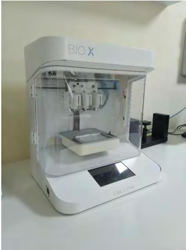
El equipo dispone de cabezales de impresión inteligentes (iPH), Compatibilidad con prácticamente cualquier material. Permite trabajar con hidrogeles (de reticulación química o con luz ultravioleta) y termoplásticos (en polvo o microgranza)
