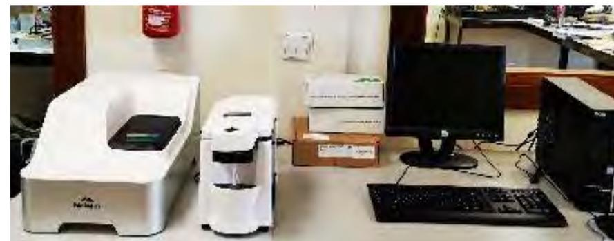
Utilizado para la determinación de la distribución de tamaños de partículas nanométricas y determinaciones de la distribución del potencial zeta en superficie.
