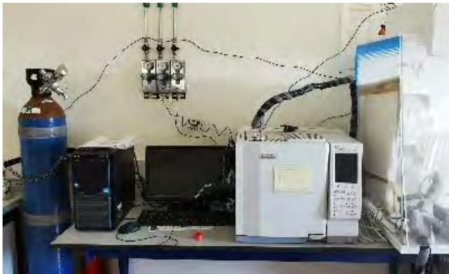
La cromatografía de gases es una técnica de separación que nos permite determinar los diferentes componentes de una muestra compleja formada por compuestos volátiles. Esta técnica utiliza como fase móvil una gas inerte que arrastra los diferentes componentes de la muestra a través de la columna cromatográfica donde son separados por la combinación de diversos procesos de interacciones físicas y/o químicas entre los componentes de la muestra y la fase estacionaria.
