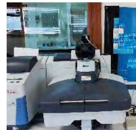
La **microscopía confocal Raman** es una técnica fotónica de alta resolución que proporciona en pocos segundos información química y estructural de casi cualquier material o compuesto orgánico y/o inorgánico permitiendo así su identificación. El análisis se basa en el examen de la luz dispersada por un material al incidir sobre él un haz de luz monocromático (radiación láser).
