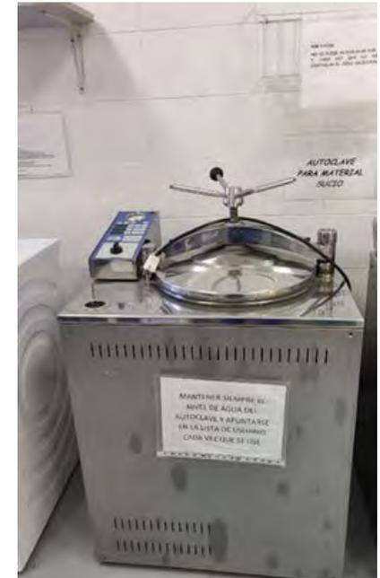
Indicado para la esterilización de medios de cultivo, líquidos, vidrio, plástico, elementos metálicos, bolsas de deshecho, fermentadores, etc.
