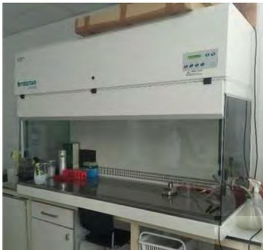
**Cabina de Flujo laminar TELSTAR MINI V/PCR**
