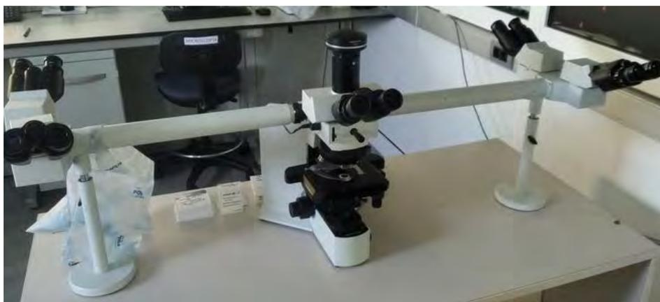
El BX51 es un microscopio robusto con controles frontales fáciles de operar en un diseño compacto. El nuevo microscopio de investigación incluye el incomparable sistema óptico de corrección a infinito UIS (Universal Infinity System) de Olympus, aceptando las tecnología en fluorescencia o el contraste de interferencia diferencial DIC (Nomarski).
