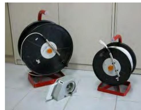
Sondas para medir niveles piezométricos y profundidad en pozos y sondeos. Dentro de las eléctricas hay una de 200 metros, dos de 300 metros y una de 500. Además se dispone de una sonda mecánica de profundidad y nivel de 200 metros.
