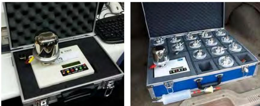
El detector de radón RM-2 está diseñado para un análisis rápido y preciso in situ del radón ( $^{222}\text{Rn}$ ) en el gas en tierra, por lo tanto, es muy aplicable al mapeo del riesgo de radón y la evaluación del contenido de radón en los suelos de cimentación.
