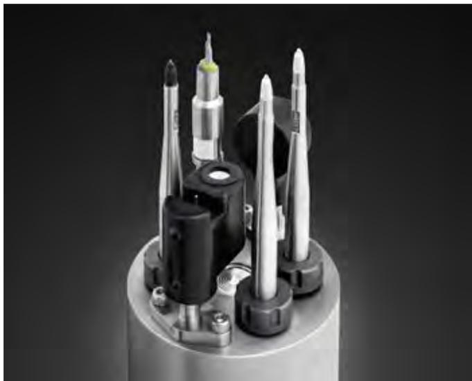
Usado principalmente para la medida de microturbulencias en el océano hasta una profundidad de 1.000 metros.
