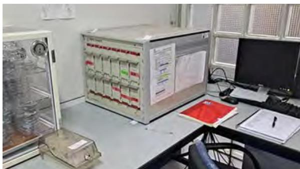
Instrumento de espectroscopia alfa completamente integrado, con Electrónica y vacío controlados al 100% por ordenador.
