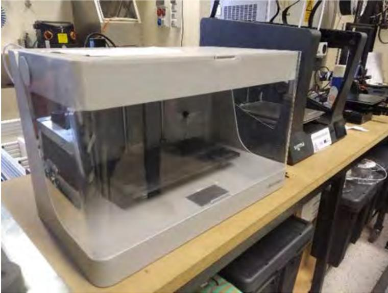
La máquina está diseñada para una maniobrabilidad y mantenimiento fáciles, desde componentes de desgaste de fácil acceso (como boquillas y tubos de alimentación) hasta elementos centrados en la usabilidad, como la plataforma de impresión, que puede quitarse y reemplazarse por una repetibilidad de 10  $\mu\text{m}$ .
