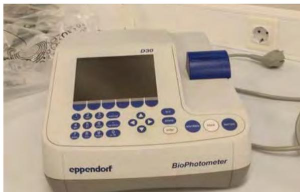
El BioPhotometer D30 es un fotómetro UV-VIS para la medición de líquidos en cubetas. Como los datos de medición son recogidos con longitudes de onda fijas, el equipo es especialmente adecuado para aplicaciones de rutina en los campos de la biología molecular, biotecnología, bioquímica y biología celular para trabajos de investigación y desarrollo.
