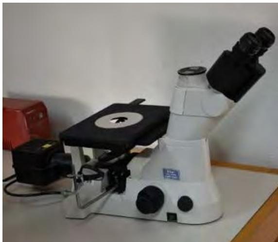
MA100N es un microscopio invertido con iluminación episcópica para la inspección de rutina de materiales y componentes industriales, así como para investigación y desarrollo.
