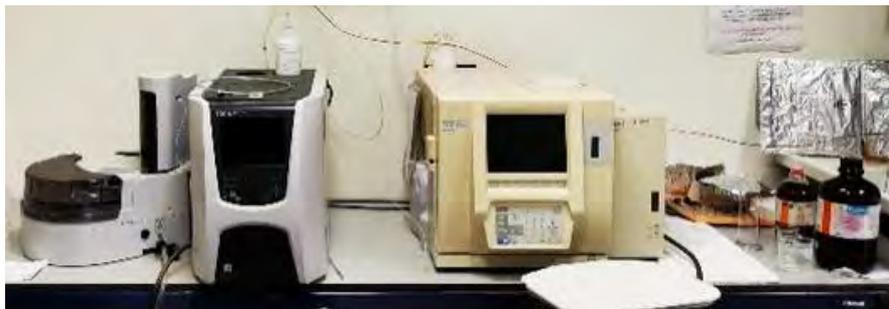
Sistema de medición de carbono orgánico total en aguas (TOC). Aunque la materia orgánica no tiene por qué ser tóxica, una elevada concentración en el agua puede tener un impacto significativo en los ecosistemas y dañar los equipos que no se supervisan ni se tratan.
